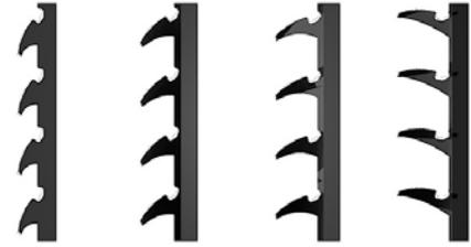
Vigueta tubular de aluminio extrusionado con encastes que permiten la dilatación de las lamas e inclinaciones de 25°, 45°, 60° y 90°
