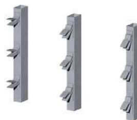
Vigueta tubular de aluminio extrusionado con pinzas que permiten la dilatación de las lamas e inclinaciones de 45°, 60° y 90°
