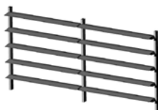
Lamas voladas respecto a sus soportes
