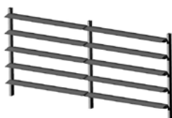
Lamas voladas respecto a sus soportes
