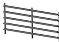
Lamas voladas respecto a sus soportes
