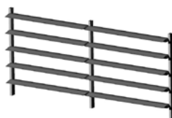
Lamas voladas respecto a sus soportes
