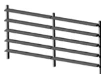
Lamas voladas respecto a sus soportes
